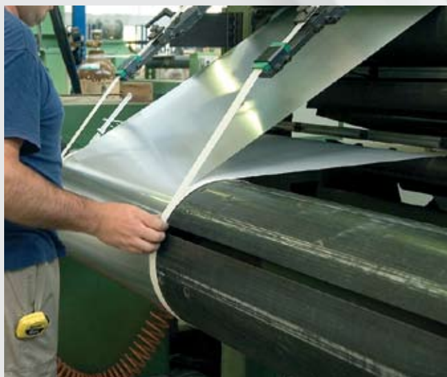
Намотка обмотки низкого напряжения
